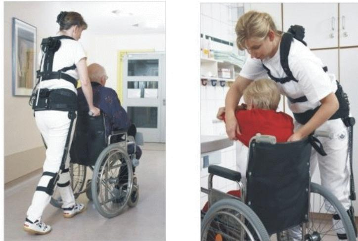
**Abb. 1:** Das CUELA-Messsystem im Einsatz auf einer chirurgischen Station
